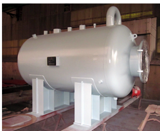
熱電廠用水罐 直徑 3m 長 5m 容量 13 m³
