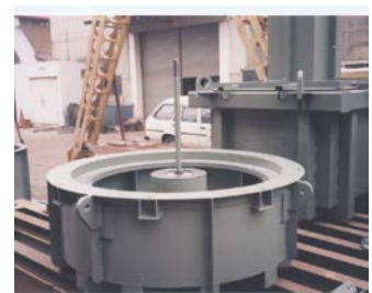
核電站用遮蔽容器 內部 鉛鑄造
